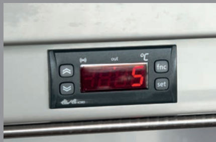
Kühlregler/Kühlanzeige zur Steuerung der Kompressorkühlung
