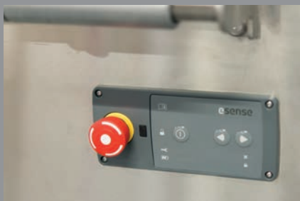
Kontroll-Panel für Antrieb mit Not-Aus-Schalter
