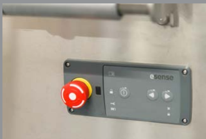
Kontroll-Panel für Antrieb mit Not-Aus-Schalter
