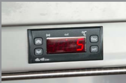
Kühlregler/Kühlanzeige zur Steuerung der Kompressorkühlung
